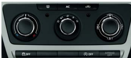
Klimatizace, tlačítko systému Start-Stop a systém ESP
